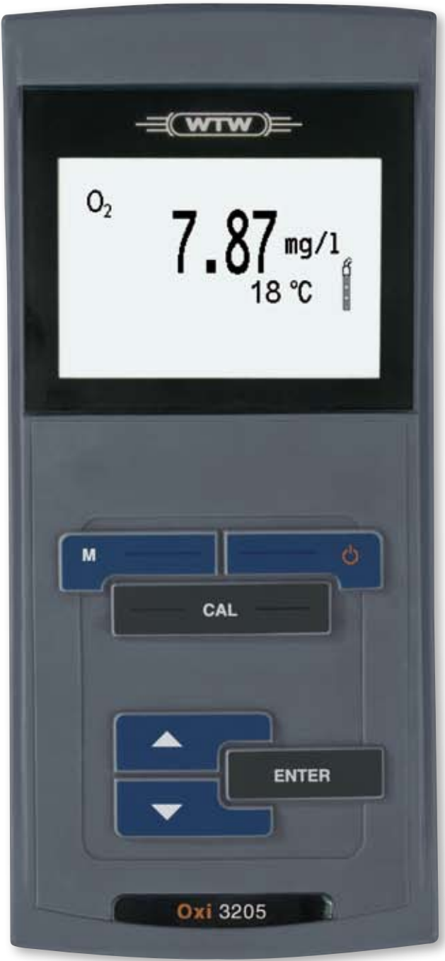
Sauerstoffmessung mit ProfiLine Oxi 3205 und DurOx® mit Verbißschutz in der Fischzucht
